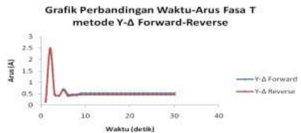
Gambar 14 Grafik waktu–arus fasa T metode metode Y- $\Delta$  *forward* dan *reverse*
