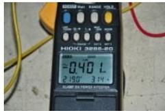
Gambar 15. Pengukuran Daya Masukan Inverter
