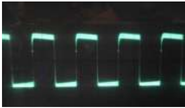
Gambar 9 Gelombang hasil pengukuran tegangan keluaran rangkaian driver dan isolator pulsa IC4047
