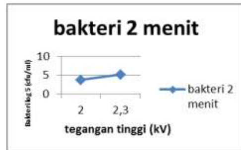
Gambar 14 Grafik Hubungan Antara Tegangan Tinggi pulsa dan jumlah bakteri dengan frekuensi sama 4,22kHz selama 2 menit
