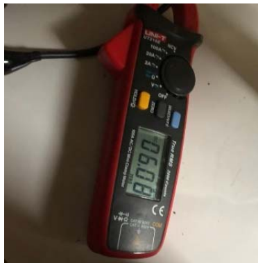
Gambar 7. Pengujian Arus Charger .
