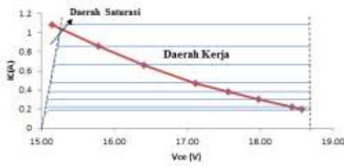
Gambar 18. Grafik daerah kerja Transistor SC2555 pada beban induktif
