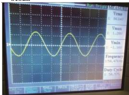
Gambar 11. Gelombang keluaran INA 121P pada saat ada beban
