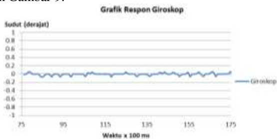
Gambar 8 Grafik sensor gyroscope ketika diam (tidak berotasi).
