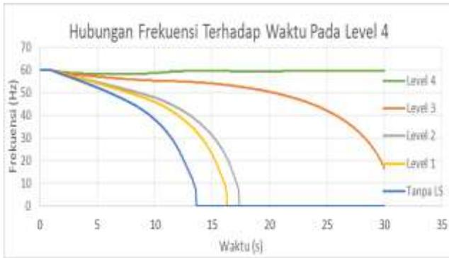
Gambar 6. Respon Frekuensi Simulasi Pelepasan Beban Kasus A 3 Dengan Load Shedding
