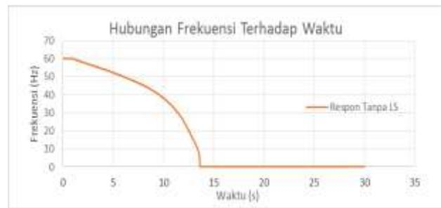
Gambar 5. Respon Frekuensi Simulasi Pelepasan Beban Kasus A 3 Tanpa *Load Shedding*
