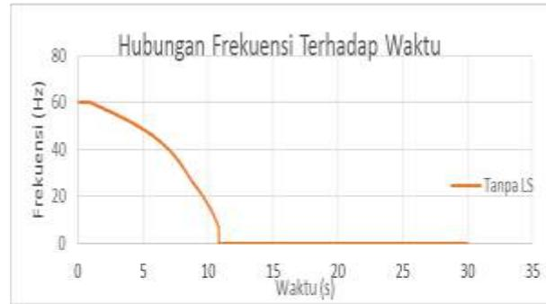
Gambar 7. Respon Frekuensi Simulasi Pelepasan Beban Kasus A 6 Tanpa Load Shedding
