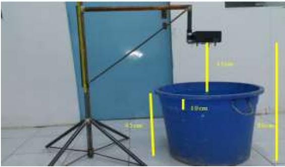
Gambar 13 Pengujian ketelitian sensor
