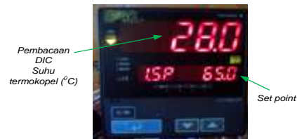
Gambar 13 Suhu termokopel yang terbaca DIC.
