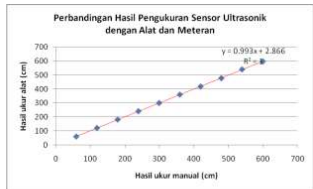
Gambar 12 Grafik perbandingan hasil pengukuran sensor ultrasonik dengan alat dan meteran
