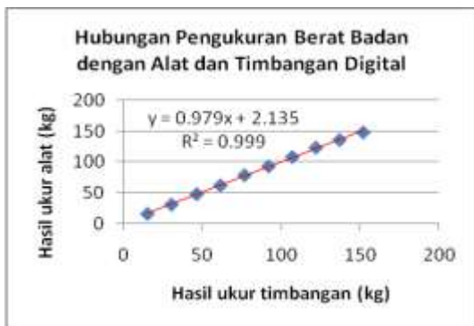
Gambar 15 Grafik Hubungan Hasil Perhitungan Berat dengan Alat dan Timbangan Digital
