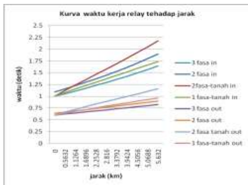
Gambar 11. Kurva waktu kerja relay terhadap jarak
