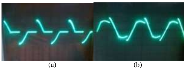
Gambar 5 (a) gelombang tegangan 170 V beban resistif (b) gelombang tegangan 170 V beban induktif
