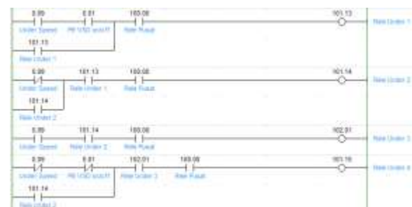
Gambar 3.17 Kerja under speed pada PLC
