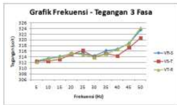
Gambar 40. Grafik frekuensi-tegangan tidak terkopel beban
