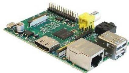
Gambar 1. Raspberry Pi tipe B
