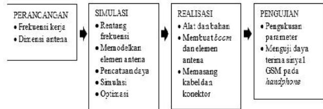
Gambar 1. Diagram penelitian antena *cubical quad*.
