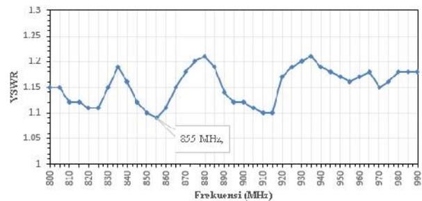
Gambar 13. Grafik pengujian VSWR antenna *cubical quad* dengan 6 direktor.
