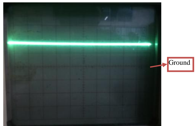
Gambar 10. Bentuk gelombang keluaran catu daya DC dengan beban inverter yang terhubung dengan rangkaian resonansi berbasis kumparan Tesla
