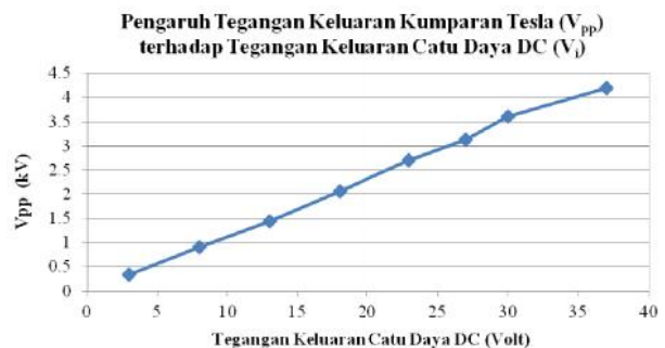
Gambar 12. Grafik tegangan keluaran kumputan Tesla ( V_{pp} ) terhadap perubahan tegangan keluaran catu daya DC ( V_i )
