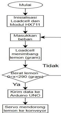
Gambar 12 Diagram alir dari penggunaan sensor load cell dan driver HX711.
