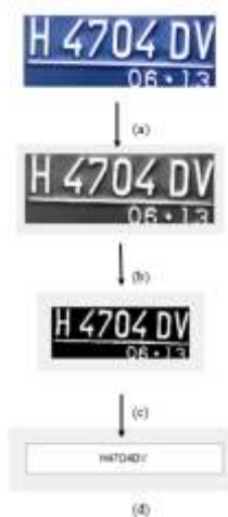
Gambar 13 (a) Citra Asal, (b) Citra Grayscale, (c) Citra Biner, (d) Hasil Pengenalan
