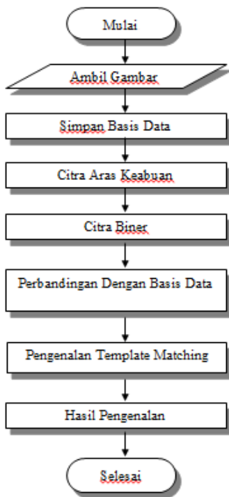
Gambar 5. Diagram Alur Perancangan Sistem template matching
