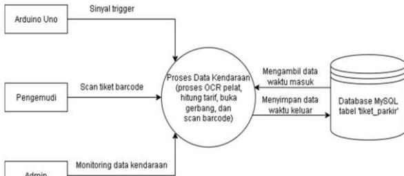
Gambar 7. Data Flow Diagram (DFD) Level 0 sistem manajemen data kendaraan.
