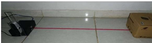
Gambar 14. Pengujian sensor ultrasonik pada jarak 60cm.
