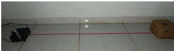
Gambar 13. Pengujian sensor ultrasonik pada jarak 100cm.
