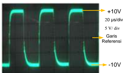
Gambar 11 Gelombang keluaran driver dan isolator pulsa
