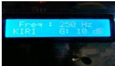
Gambar 11. Tampilan untuk mengatur frekuensi dan intensitas pada audiometer untuk telinga kiri (manual)
