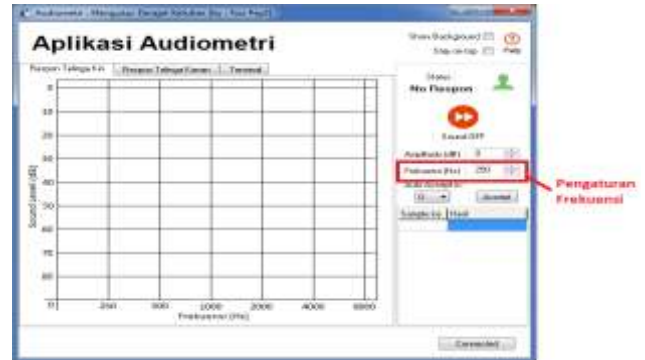
Gambar 4. Aplikasi audiometer berbasis mikrokontroler menggunakan antar muka komputer pada pengaturan frekuensi
