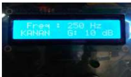
Gambar 14. Tampilan untuk mengatur frekuensi dan intensitas pada audiometer untuk telinga kanan (manual)
