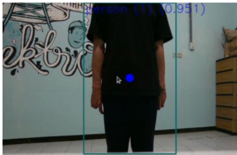
Gambar 7. Hasil pendeteksian manusia pada jarak 0,5 meter.
