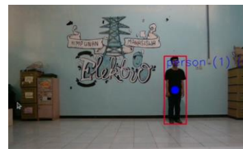
Gambar 11. Hasil pendeteksian manusia pada jarak 3,5 meter.
