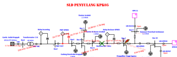
Gambar 18. Urutan Kerja Relai Proteksi Setelah Dipasang Recloser
