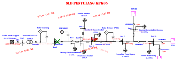
Gambar 5. Urutan Kerja Relai Proteksi
