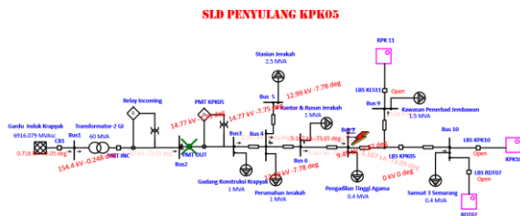
Gambar 17. Urutan Kerja Relai Proteksi Sebelum Dipasang Recloser
