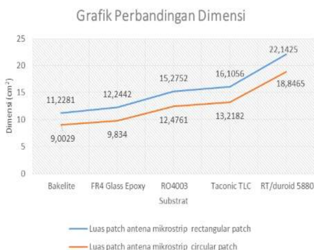
Gambar 10. Grafik Perbandingan Dimensi Antena Mikrostrip Rectangular Patch dan Antena Mikrostrip Circular Patch
