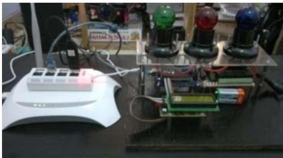
Gambar 3 TP-Link MR3220v2 yang terhubung dengan ATmega8535
