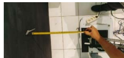
Gambar 19. Pengukuran Jarak Asli Antara Objek dan Kamera
