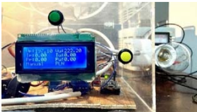
Gambar 15. Kondisi ATS mode manual PLN saat PLN undervoltage (beban tidak disuplai)
