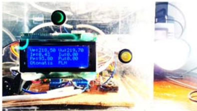
Gambar 8. Kondisi ATS mode otomatis saat PLN kembali menyala (suplai PLN)
