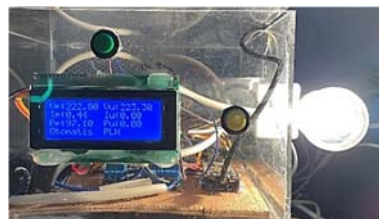
Gambar 6. Kondisi ATS mode otomatis saat PLN normal (suplai PLN)
