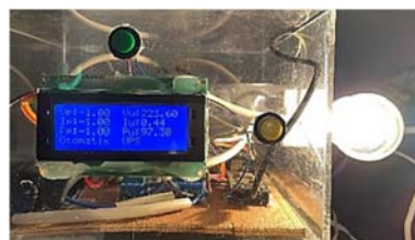
Gambar 7. Kondisi ATS mode otomatis saat PLN padam (suplai UPS)
