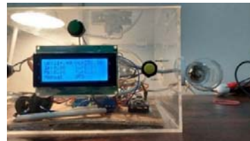
Gambar 19. Kondisi ATS mode manual UPS saat UPS overvoltage (beban disuplai UPS)
