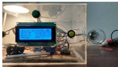
Gambar 18. Kondisi ATS mode manual UPS saat UPS undervoltage (beban disuplai UPS)
