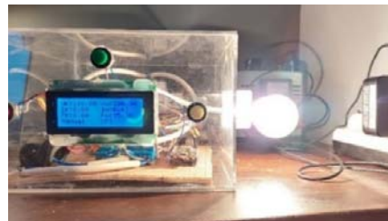
Gambar 17. Kondisi ATS mode manual UPS saat UPS normal (beban disuplai UPS)
