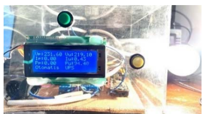
Gambar 10. Kondisi ATS mode otomatis saat PLN overvoltage (suplai UPS)
