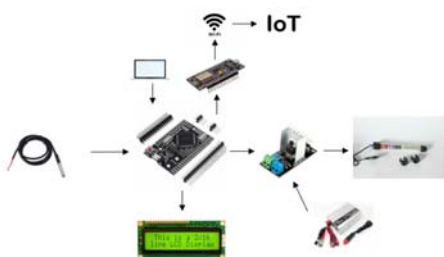
Gambar 2. Desain perangkat keras sistem kendali dan monitoring suhu air
