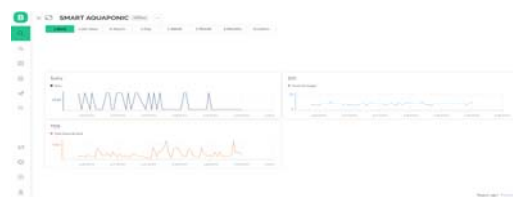
Gambar 15. Tampilan sistem monitoring parameter suhu, DO dan TDS secara online menggunakan aplikasi Blynk.
