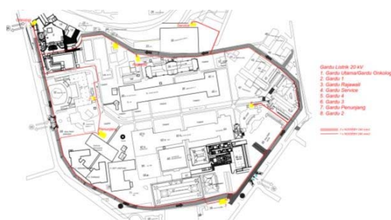
Gambar 3. Siteplan Perencanaan Saluran Tegangan Menengah 20 kV
