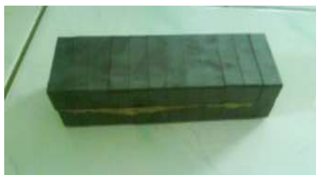
Gambar 1 Magnet keramik Magnet Fe yang digunakan berdimensi p = 6 cm, l = 2.5 cm, t = 1.2 cm
