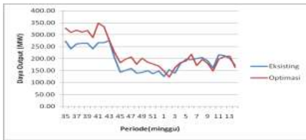
Gambar 4.9 Perbandingan Daya Output Pola Operasi Simulasi Optimasi dengan Operasi Eksisting Menggunakan Debit Air Sama Besar
