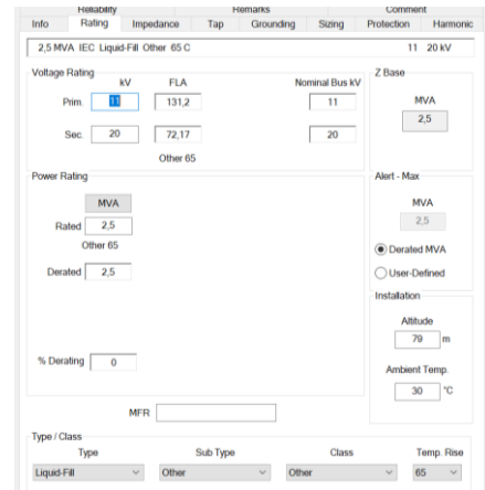
Gambar 7. Data transformator PLTM Kambangan
