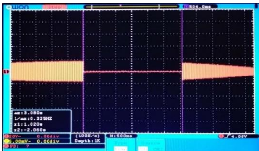
Gambar 14. Gelombang peralihan dari Inverter ke PLN
