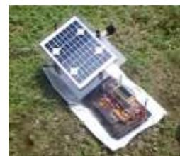
**Gambar 23. Pengujian Sistem Dengan Kendali Logika Fuzzy (KLF) 2 DOF**
