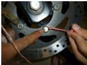
Gambar 7. Pemasangan magnet pada baut cakram
