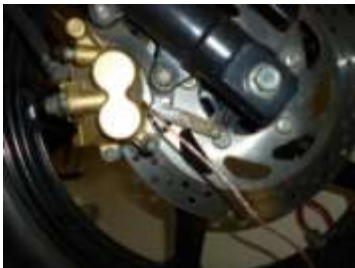
Gambar 8. Pemasangan sensor pada dudukan master rem
