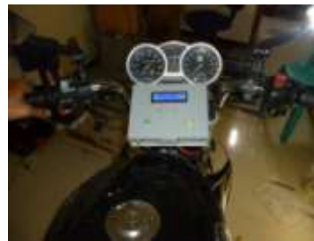
Gambar 9. Pemasangan kotak argometer pada dudukan kemudi
