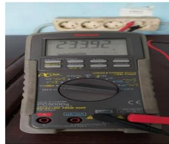
Gambar 4. Nilai Tegangan AC satu Fasa PLN
