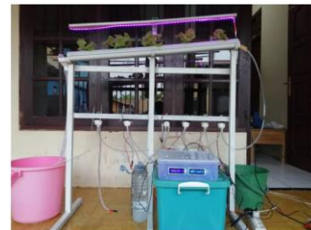
Gambar 13. Implementasi perangkat keras pada alat monitoring dan pengendalian nutrisi hidroponik
