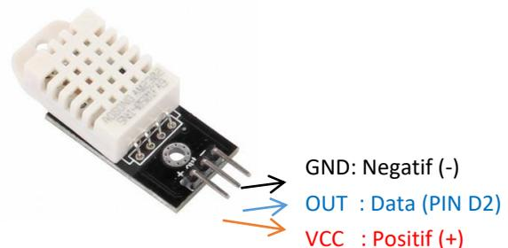
Gambar 2. Rangkaian sensor DHT22
