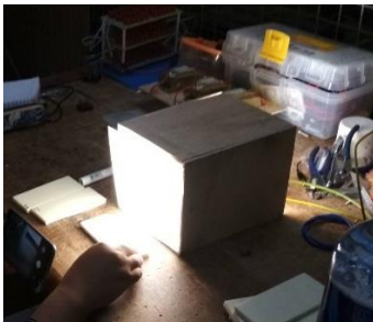
Gambar 6. Penetesan dan pengambilan gambar polutan pada bahan uji
