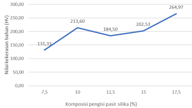
Gambar 23. Grafik nilai kekerasan bahan dengan variasi penambahan bahan pengisi pasir silika
