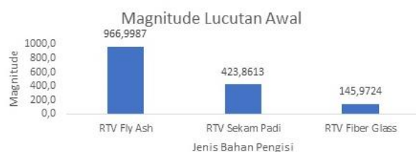
Gambar 18. Grafik Magnitude Menggunakan Metode Acoustic Emission Properties of Partial Disharge pada Lucutan Awal
