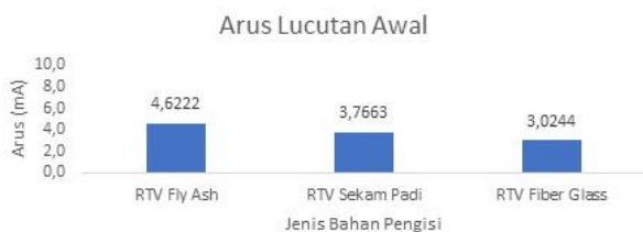
Gambar 17. Grafik Arus Bocor Menggunakan Metode Inclined-Plane Tracking pada Lucutan Awal
