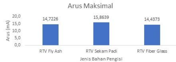
Gambar 14. Grafik Perbandingan Jenis Bahan Pengisi dengan Arus Bocor Maksimal
