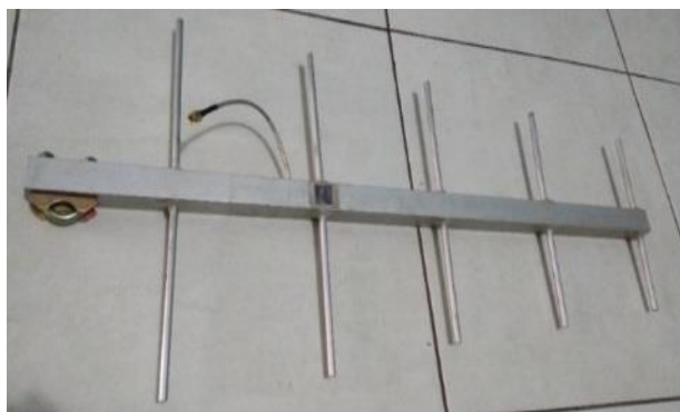
Gambar 1. Antena Yagi – Uda 433MHz yang telah dipabrikasi.
