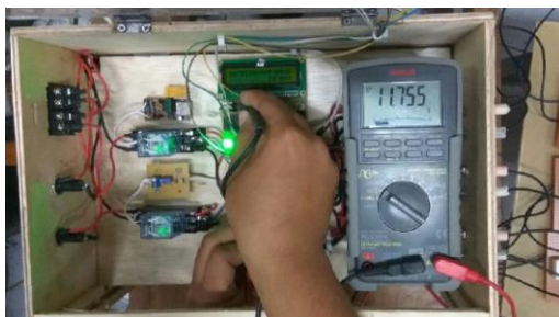
Gambar 8. Hasil pengujian tegangan keluaran driver relay
