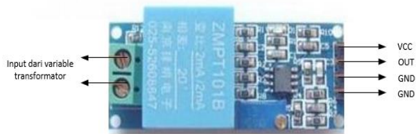
Gambar 2. Konfigurasi pin sensor ZMPT101B
