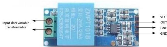
Gambar 2. Konfigurasi pin sensor ZMPT101B
