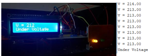
Gambar 10. Kondisi Under Voltage
