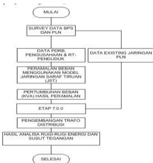
Gambar1 Diagram Alir Pengembangan trafo distribusi
