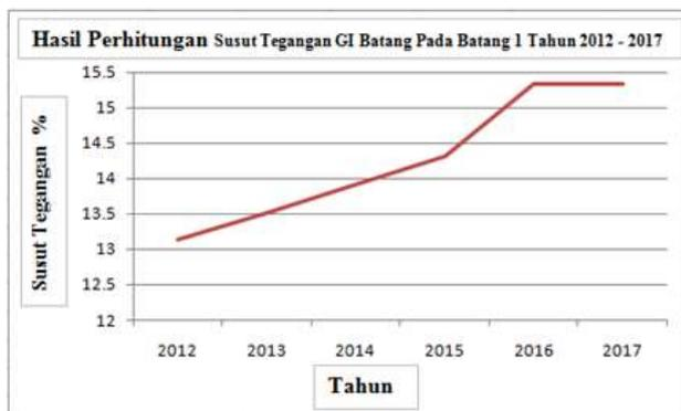
**Gambar 12 Hasil Perhitungan Peramalan Susut Tegangan GI Batang Pada Batang 1**
