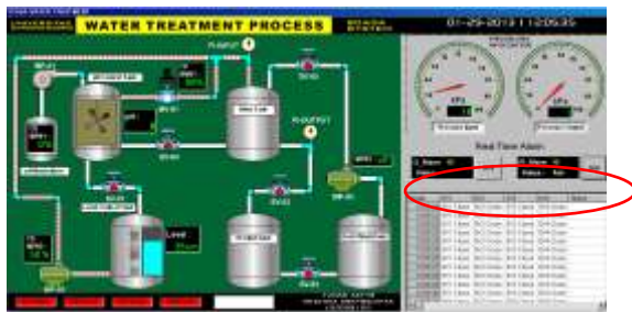
Gambar 14 Tampilan pengujian peringatan alarm
