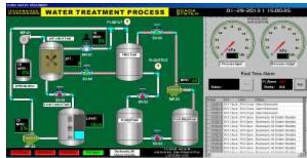
Gambar 16 Tampilan pengujian proses backwash
