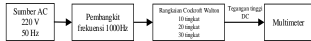
Gambar 2. Blok diagram sistem pembangkit tegangan tinggi DC metode Cockcroft-Walton tipe fullwave sumber 220 V 1000 Hz
