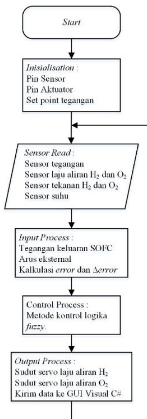
Gambar 3. Diagram alir kontroler laju aliran H_2 dan O_2
